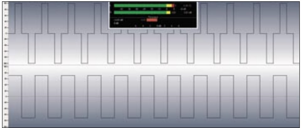
Abbildung 1: Ein Extrembeispiel für die Samplepeak-Fehleranfälligkeit. Zwei gleiche Sinusschwingungen bei gleichem Pegel und gleicher Frequenz von 11025 Hz. Der untere Sinus (durch die Auflösung von 44,1 kHz in der Sampledarstellung nicht als Sinus erkennbar) wurde um 45° verschoben, hat aber den gleichen realen Ausgangspegel. Der entstehende Pegelmessfehler beträgt über 3 dB
